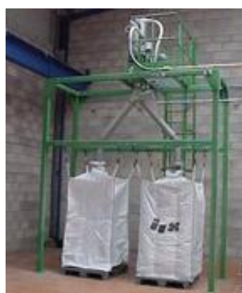
Διπλή μονάδα γεμίσματος Big-Bags
